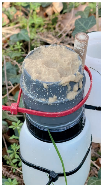
Splash-Cup, aus dem Regen Sand herausgeschleudert hat. (Foto: KIT, Aurélié Orphal)
