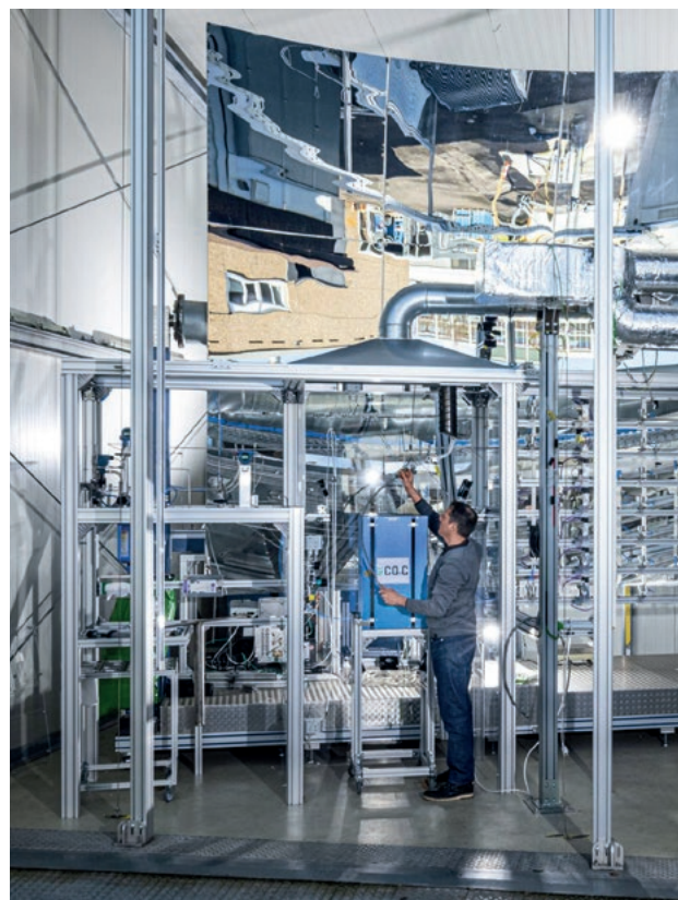
Die NECOC-Versuchsanlage am KIT, in der aus CO 2 fester Kohlenstoff hergestellt wird. (Foto: KIT, Markus Breig)
