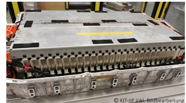
Das Foto zeigt ein (halb)demontiertes Batteriemodul. Foto: KIT-IIP (incl. Bildbearbeitung)
